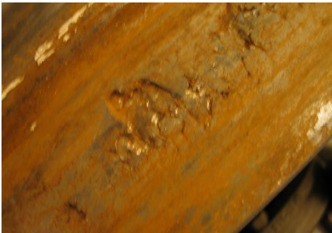
Figur 5: Løbefladeskader (kilde: DSB: Løbefladeskader på IC4, togsæt 5618)
