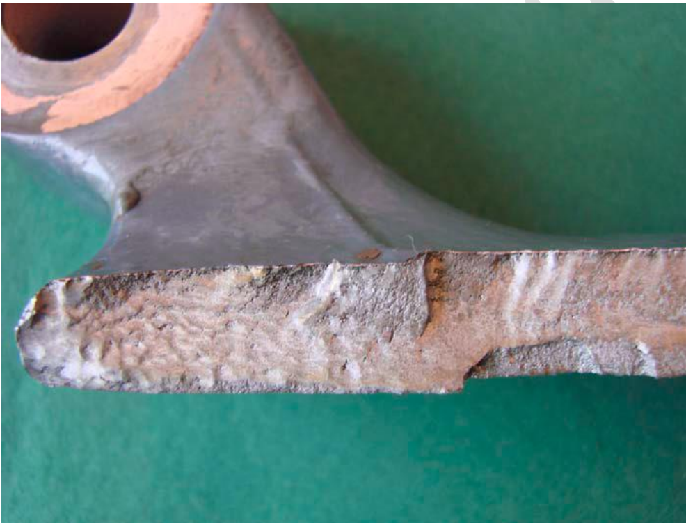
Figur 4: Detailsnit af revnested (kilde: /12/)
