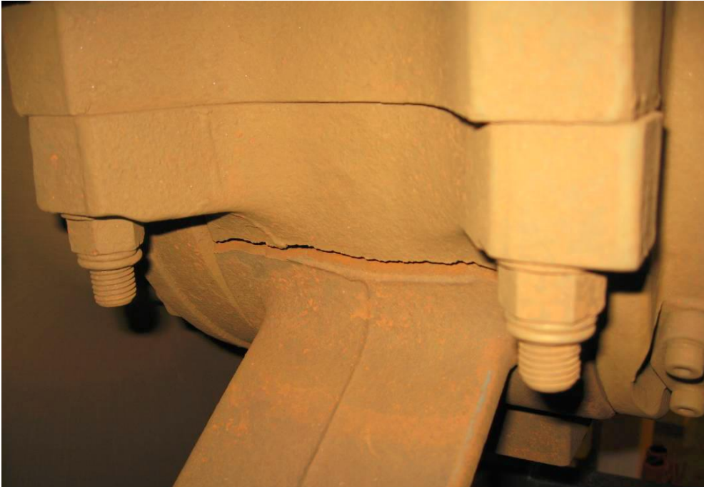
Figur 3: Nederste aksellejekasse med revne (kilde: /12/)
