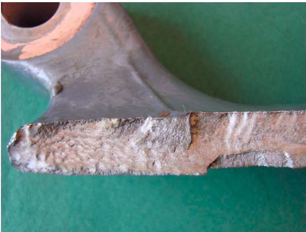
Abbildung 4: Detailansicht der Rissstelle (Quelle: /12/)
