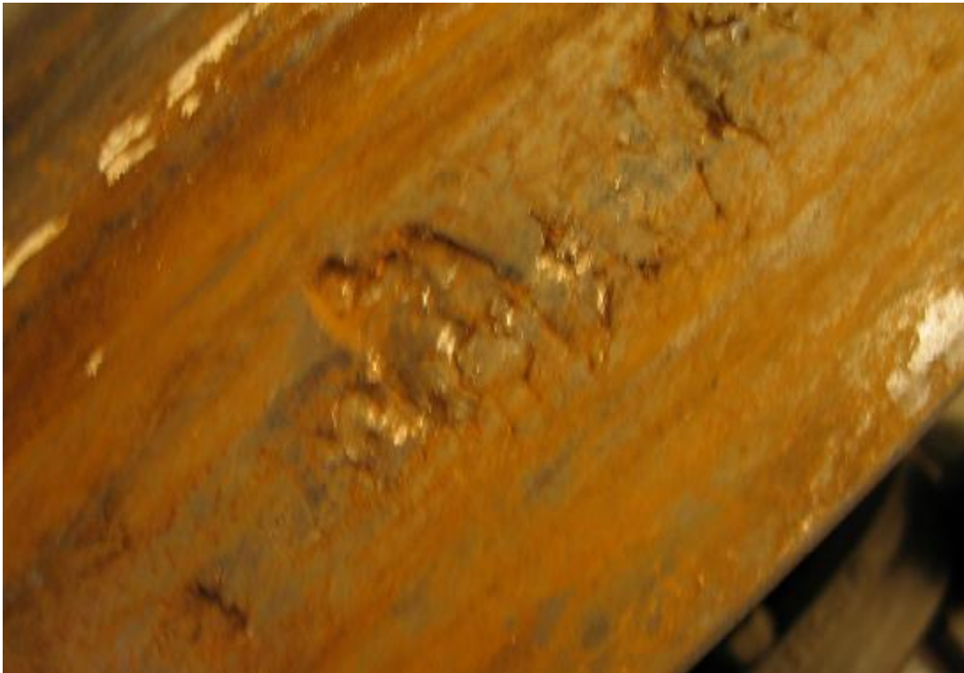
Abbildung 5: Lauffläschenschäden (Quelle: DSB: Lauffläschenschaden am IC4, Triebzug 5618)
