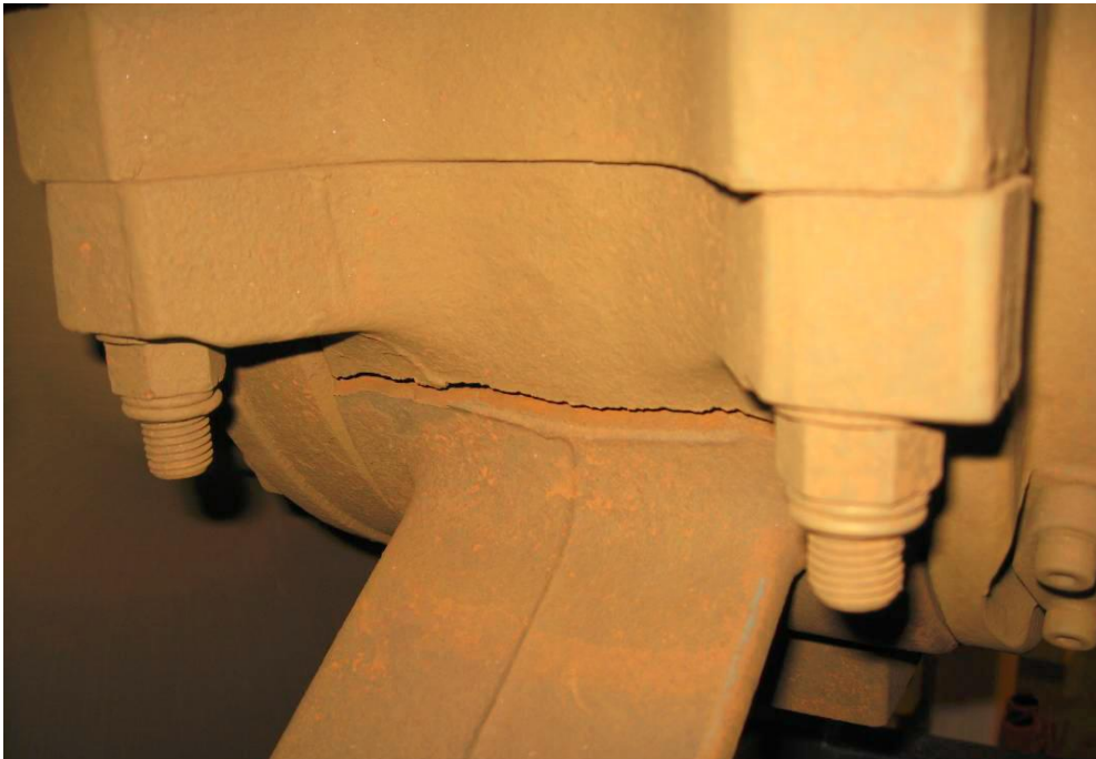
Abbildung 3: Unteres RSL-Gehäuse mit Riss (Quelle: /12/)
